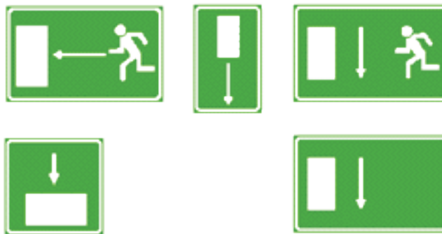
Vía/salida de socorro
