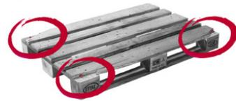
Los europalets cuyo estado no es conforme a los criterios de reutilización indicados deben repararse conforme a UIC 435-4. La reparación de europalets sólo puede realizarse con una licencia de EPAL. Sólo pueden emplearse piezas con las dimensiones exactas conforme a UIC 435-2 y UIC 435-4. Los europalets reparados deben tener las mismas propiedades técnicas que un europalet nuevo.
